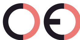
Marca CE falsa (demasiado separados)
